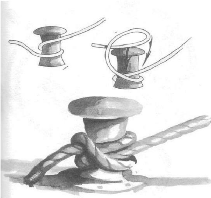
Figuur 48: vastleggen aan bolder 2 e manier middels mastworp.
